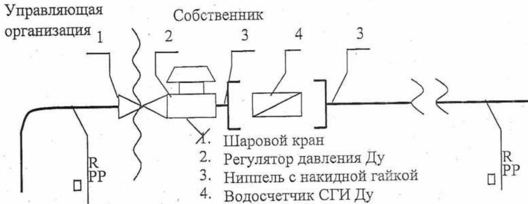
Исполнитель несет ответственность за надлежащее состояние и работоспособность систем горячего и холодного водоснабжения согласно нижеуказанной схеме до волнистой линии слева (включая шаровой кран).
